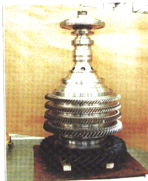
Fig 8 : Rotor de compresseur HP expérimental testé en 1997. Architecture hybride à P/P = 11.4 en 5 étages
